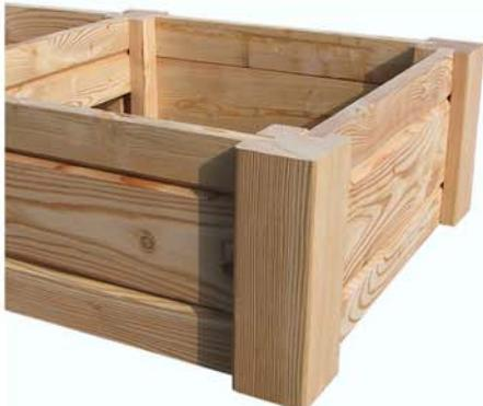
Konstrukce výrobku je spojením dřeva do dřeva pomocí drážky. Na spojení horního rámu a nosných hranolů používáme staré technologie čepu a dlabu, popř. spojení do drážky bez použití vrutů. V celé konstrukci nepoužíváme vruty a žádný spoj není viditelný.
